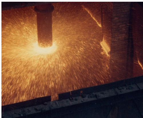
Figure 1 Granulation à sec de LHF Installation pilote - British Steel à Redcar
