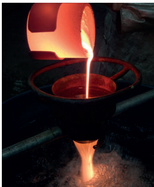
Figure 5 Granulation du laitier par voie humide en laboratoire (FEhS)
