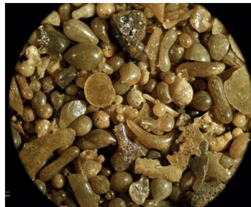
Figure 2 Laitiers granulés à sec Redcar (teneur en verre 99,5 %)
