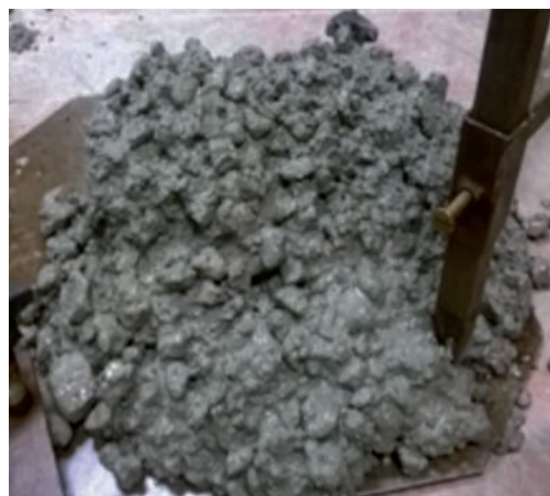
Figure 2 Illustration d'un béton de granulats de LAFE à l'état frais
