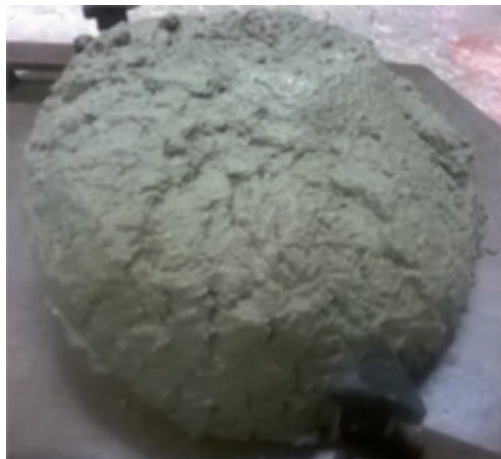
Figure 1 Illustration d'un béton de granulats naturels à l'état frais
