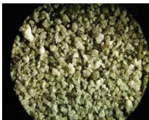
Figure 7 Laitier typique granulé par voie humide produit à Leoben
