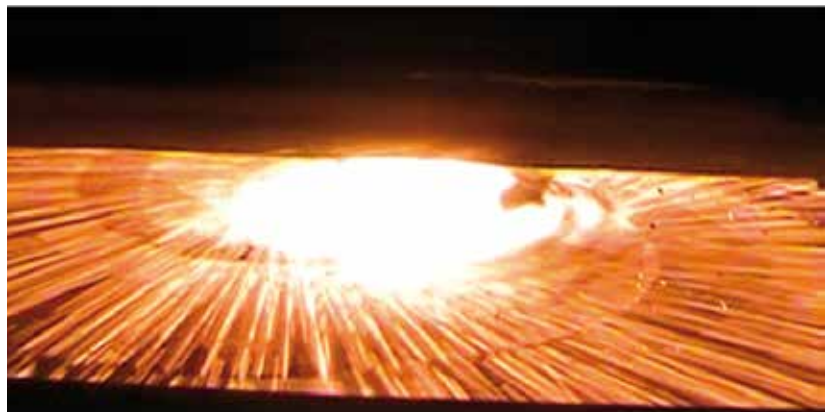
Figure 2 Atomisation du laitier liquide)
