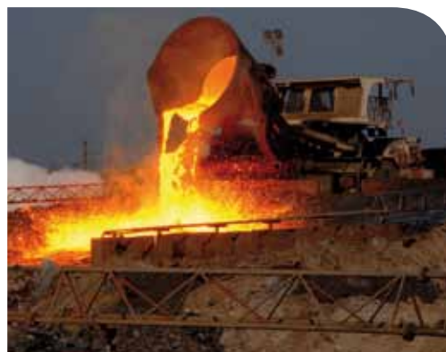
Photo 2 Déversement des laitiers d'aciérie de convertisseur en fosse (site SGA)
