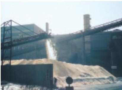
Lors du soutirage, après séparation d'avec la fonte, plus lourde, le laitier est dirigé vers un dispositif dans lequel il va subir un arrosage violent et abondant d'eau sous haute pression (trempe) destiné à le vitrifier. L'énergie calorifique contenue dans le laitier en fusion provoque son explosion et forme instantanément du laitier vitrifié. Ce dispositif s'appelle un granulateur et le laitier ainsi vitrifié, laitier granulé.
