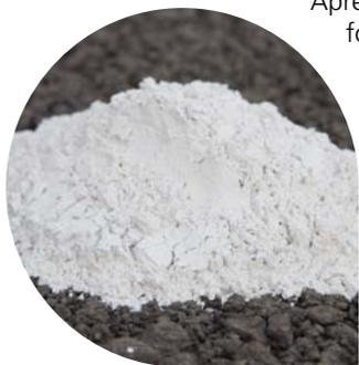
Après séchage et broyage fin du laitier granulé de haut fourneau, on obtient le laitier moulu. Trois millions de tonnes de laitier moulu sont fabriquées annuellement en Europe. Le laitier moulu commercialisé en France répond à la norme NF EN 15167-1 (septembre 2006). Selon la norme, les valeurs qui caractérisent la qualité d'un laitier moulu sont principalement l'indice d'activité (réactivité avec le ciment) et la finesse.
